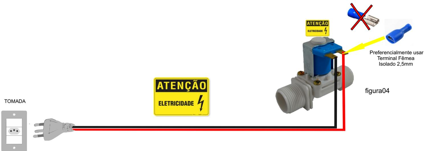
A **figura04** mostra exatamente como fica nosso circuito ligado fisicamente. O fio amarelo foi colocado para evitar erro ligação.
